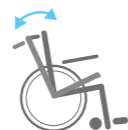
Sagitta (SI) Opcional cuadro tipo "SI" permitiendo la regulación del ángulo del asiento.
